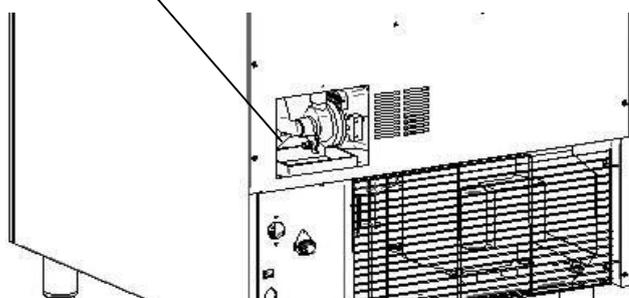
5. Preparare una soluzione di un prodotto adatto per la pulizia delle macchine (calcare). Non utilizzare acido cloridrico. Raccomandiamo l'uso di un prodotto che rimuova il calcare come Calklin e prepararlo seguendo le istruzioni del produttore.
