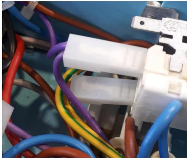
Foto: Fastons del termostato de stock.
