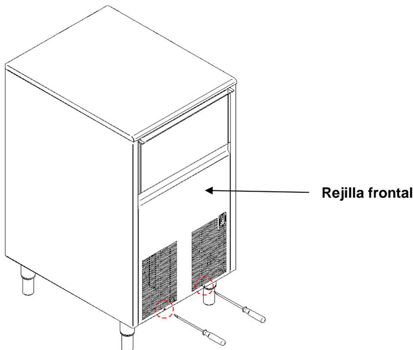
4. Pulire con l'aiuto di un aspirapolvere, una spazzola non metallica o aria a bassa pressione. Pulisci dall'alto verso il basso, non da un lato all'altro. Fare attenzione a non piegare le alette del condensatore.
