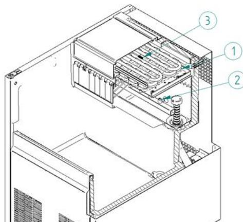
4. Preparare una soluzione di prodotto idoneo alla pulizia delle macchine per il ghiaccio (calcare). Non utilizzare acido cloridrico. Si consiglia l'uso di qualsiasi prodotto anticalcare approvato, preparato secondo le istruzioni del produttore, come CalKlin.
