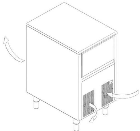
L'unità permette di lavorare ad incasso, con una riduzione della produzione.
