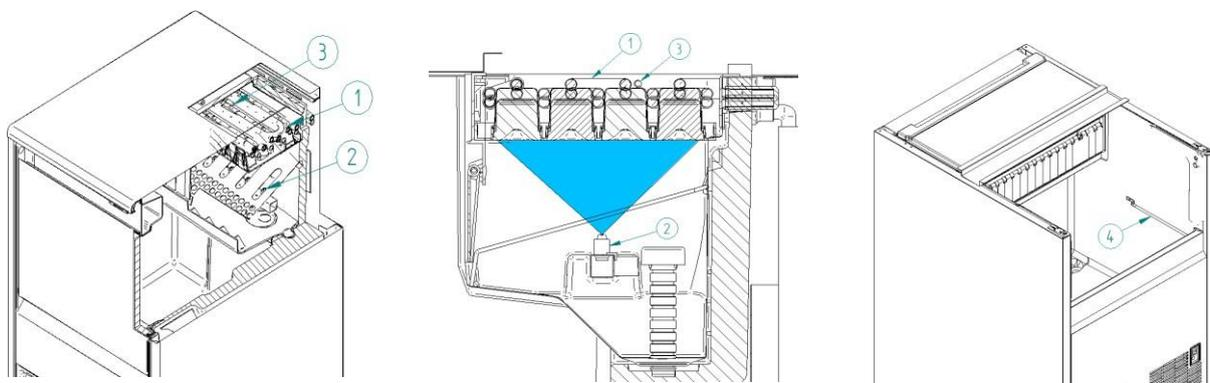
Quando la sonda di temperatura (#3) posta all'estremità dell'evaporatore raggiunge un valore impostato  $T_c$  ( $-12/-8^{\circ}\text{C}$ ), la produzione prosegue per il tempo impostato con la combinazione dei dip-switch 1-4 (vedi tabella). In questo modo possiamo garantire che il riempimento dell'ICE CUBE sia corretto nelle diverse condizioni di lavoro.
