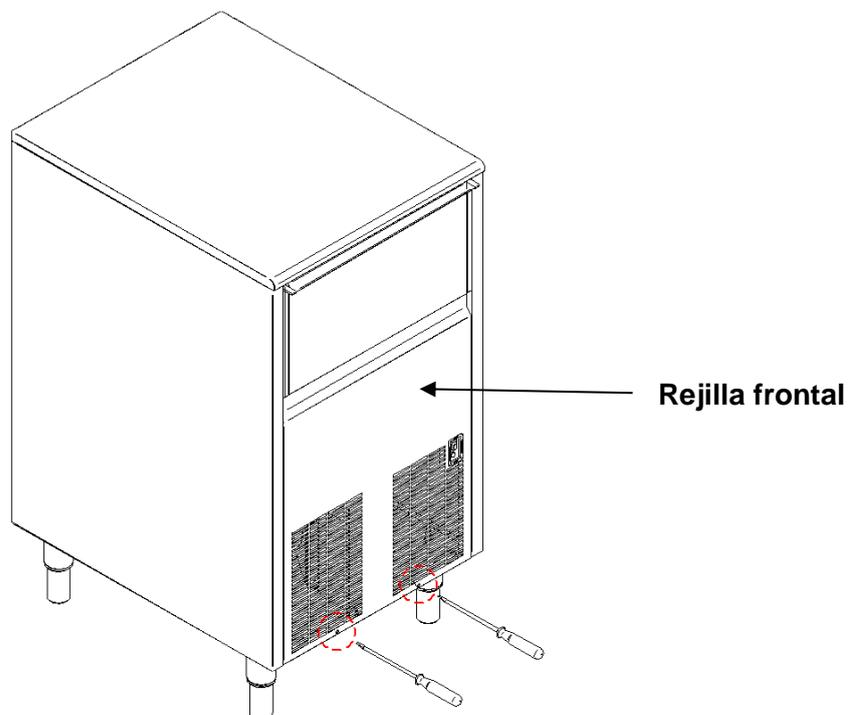
4. Limpiar con ayuda de un aspirador, brocha no metálica o aire a baja presión. Limpie de arriba a abajo, no de lado a lado. Tenga cuidado de no doblar las aletas del condensador.
