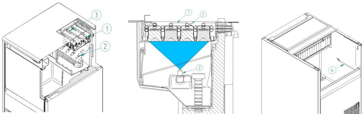
Cuando la sonda de temperatura (#3) en el extremo del evaporador alcanza un valor ajustado  $T_c$  ( $-12/-8^{\circ}\text{C}$ ), la fabricación continúa el tiempo fijado con la combinación de los dip-switches 1-4 (ver tabla). De esta manera podemos asegurar que el llenado del ICE CUBE es correcto en diferentes condiciones de trabajo.
