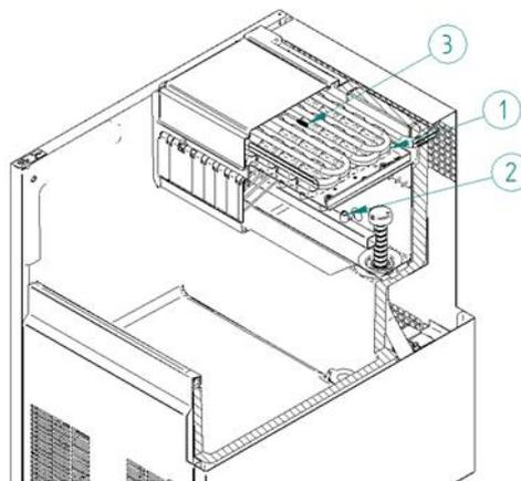
4. Prepare una solución de un producto adecuado para la limpieza de las máquinas de hielo (cal). No utilice ácido clorhídrico. Recomendamos el uso de cualquier producto aprobado para la eliminación de la cal, preparado según las instrucciones del fabricante, como por ejemplo CalKlin.
