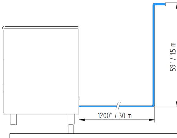
Si la tubería de desagüe discurre de forma incorrecta, es posible que la bomba no pueda evacuar el agua, ya que el caudal de la bomba puede verse influenciado por la existencia de aire almacenado dentro del circuito.
