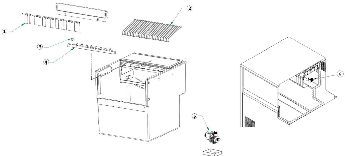
**ATENCIÓN:** ES MUY IMPORTANTE, AL SUSTITUIR EL COLECTOR QUE LOS INYECTORES ESTEN COMPLETAMENTE PERPENDICULARES AL MISMO. SI LOS CUBITOS DEL EXTREMO ESTÁN TORCIDOS, PUEDEN QUEDARSE SIN AGUA.
