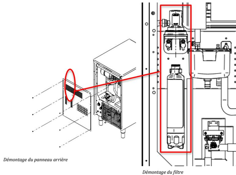
Pour changer la cartouche, il est nécessaire de retirer le panneau arrière en tôle en dévissant les 6 vis torx qui la fixent au corps de la machine.
