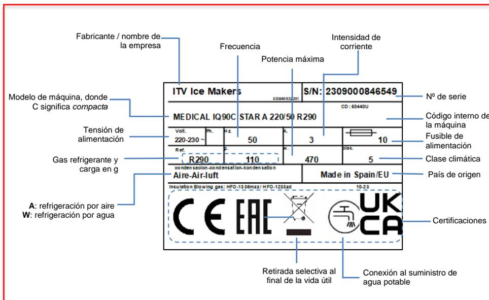
En esa etiqueta, usada como ejemplo y ubicada en la parte trasera de la máquina, se pueden ver todas las características técnicas de la máquina.
