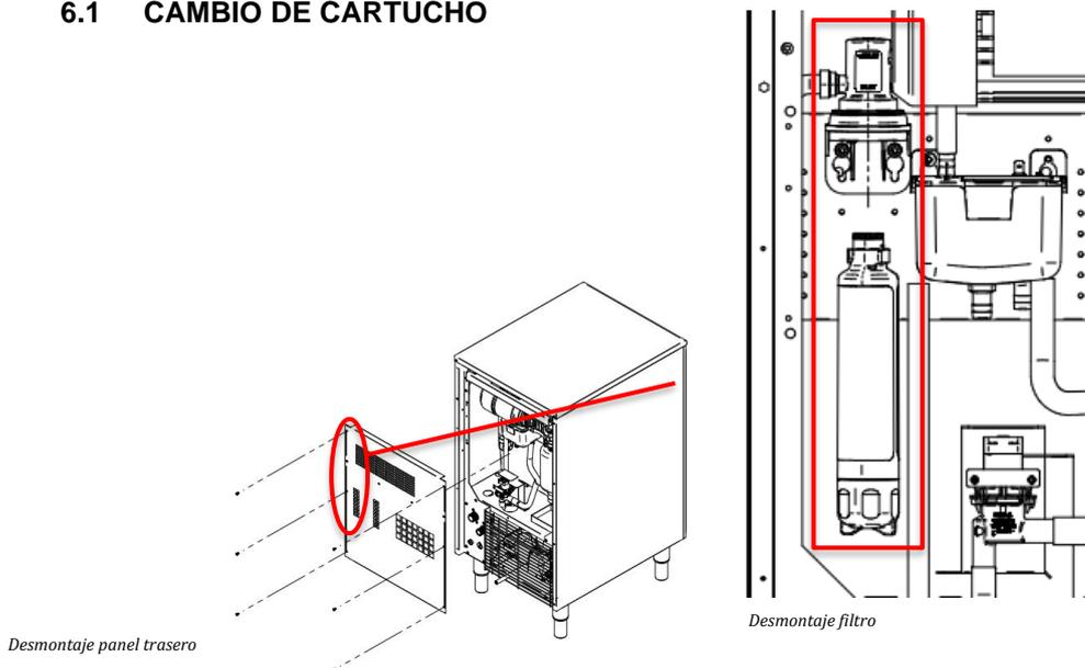
Para el cambio de cartucho es necesario quitar el panel trasero de chapa destornillando los 6 tornillos torx que lo fijan a la carrocería de la máquina.
