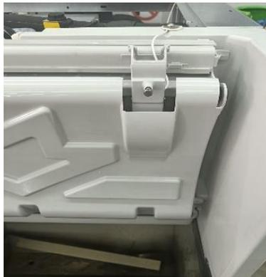
**3-** La configuración que debe tener es fija, 6mm de distancia entre el sensor y el evaporador.
