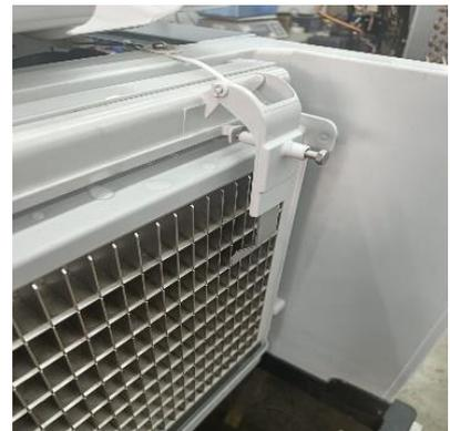
**4-** Colocar de nuevo la bandeja, primero un acople izquierdo y después otro. Comprobar funcionamiento correcto.
