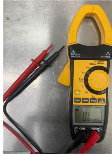
2-. Colocar el tester en la posición correcta para medir ohmios ( $\Omega$ ) y comprobar que la sonda da un valor de 10k con una temperatura de 25°C ambiente. Si el resultado es inferior a 10K, sustituir la sonda.
